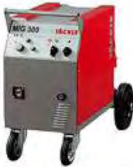
>> **Transformador trifásico**, tensión de alimentación 230/400 V. MIG 300 y 300E: interruptor 12 grados. La version E dispone de un unico regulador que ajusta automaticamente la velocidad del hilo con el voltaje de soldadura. **Funciones de control MMS-6:** control de suministro (control constante), tiempo de burn-back, 2/4 ciclos, tiempo de soldadura por puntos, selector de hilo y soft start.
