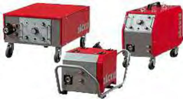
>> **DVK 4:** Sistema de arrastre (diseño horizontal), conducido por 4 rodillos, 140 W.
